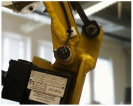
Des potentiomètres sont aussi installés sur les chevilles pour mesurer la position absolue du pied par rapport à l'axe du « tibia ». On peut voir leur montage sur la photo suivante :
