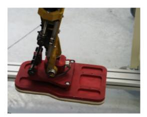
Ce type de montage va nous permettre de déterminer le profil du sol rencontré par le robot.
